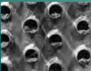
Arena y gravilla transportadas por el aire, aspiradas por los ventiladores de las torres de enfriamiento. Agua de reposición con arena y sedimentos. Precipitación de sólidos causada por el calentamiento/enfriamiento, evaporación, aceleración y/o tratamiento químico.
